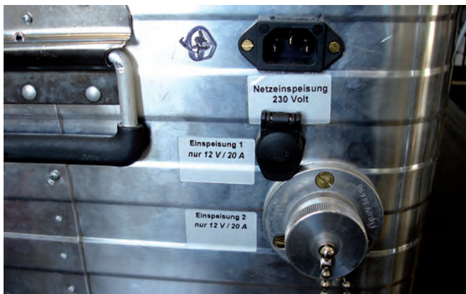
Anschlüsse zur Stromeinspeisung.
